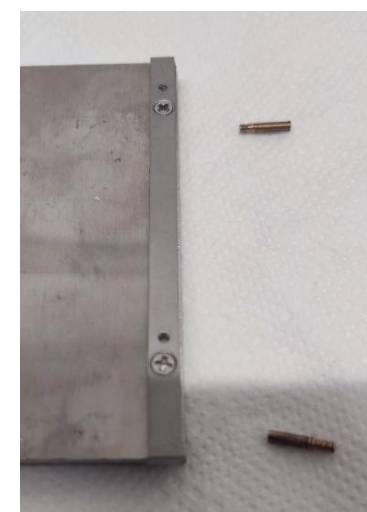
固定所有部件，定位销 用于组装下一个模块
