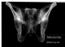
图 4.5.15 MicroMEGAS/X 射线 (75 keV) 扫描图像 (工作气体 Xe(4 bar)) [49]
