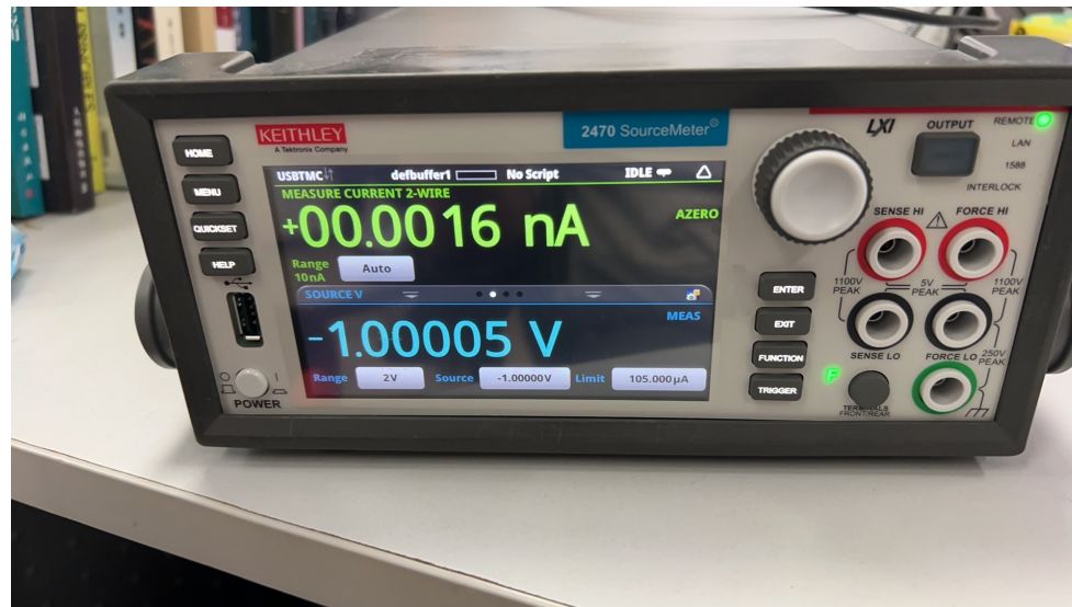
高压源（临时） Keithley 2470 ( \pm 1000\text{V} ), Keithley 6487 ( \pm 500\text{V} )
