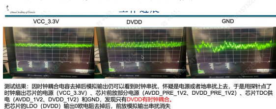
4块联合测试板不同芯片的噪声幅度
