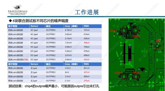
4块联合测试板不同芯片的噪声幅度
