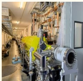
2022年5月12日 直线加速器全线真空封接
