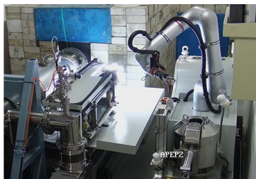
钚靶辐照、冷却及机械臂远程取靶
