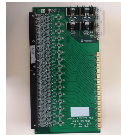
DarkSide-20k 光传输发射和接收模块
