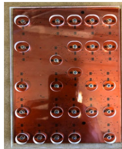
DarkSide-20k 光传输发射和接收模块
