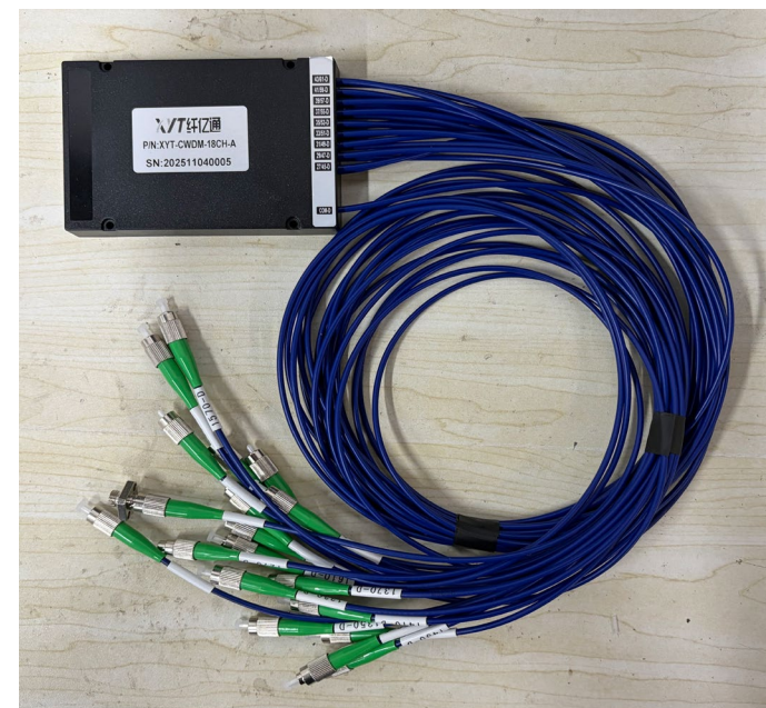
带 FC/APC 光纤跳线的波分器
