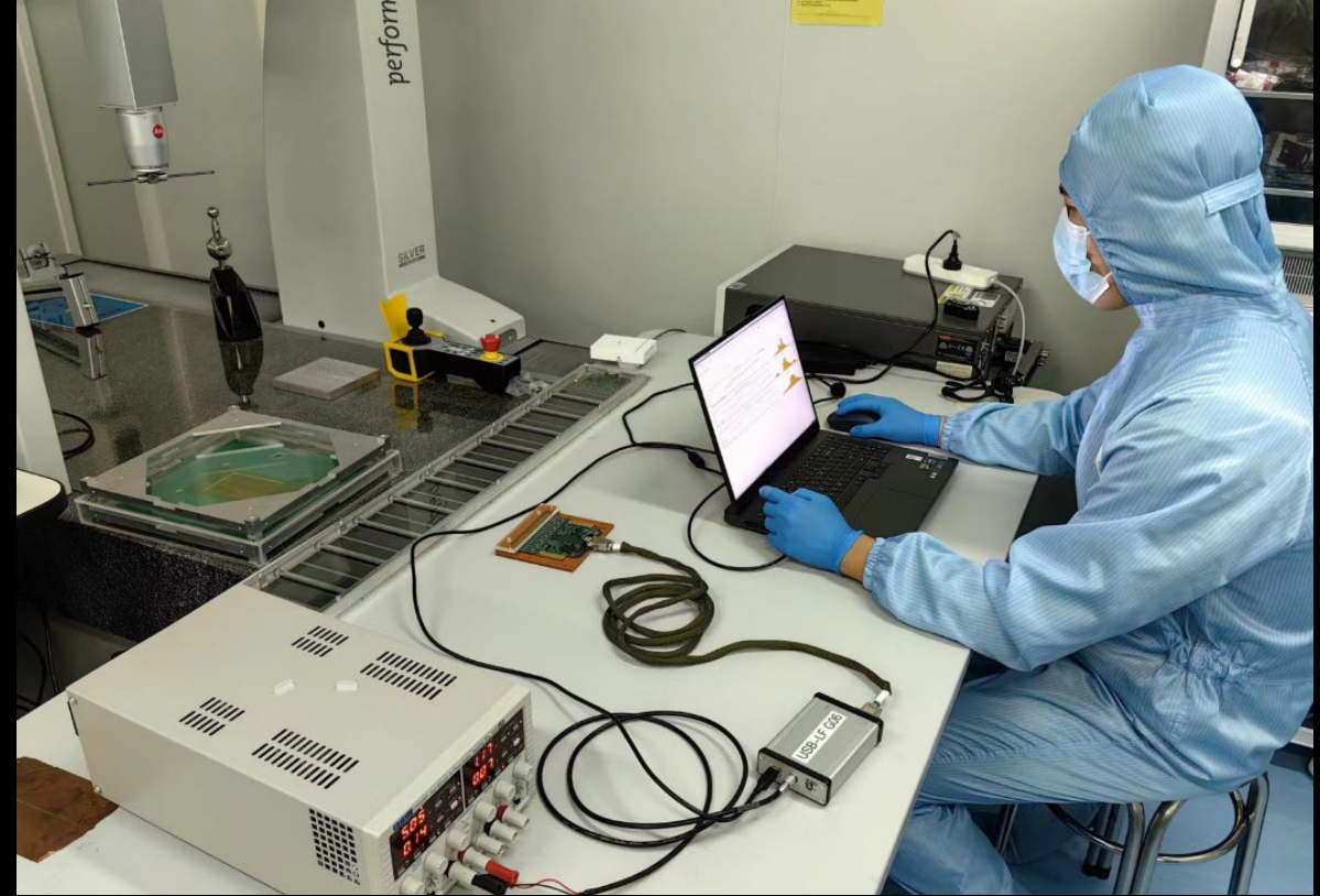
电子学测试 暗电流、噪声水平、通道连接……
