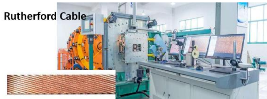
完成50米32芯NbTi卢瑟福电缆
