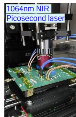
AC-LGAD传感器及专用读出 芯片LATRIC联合测试
