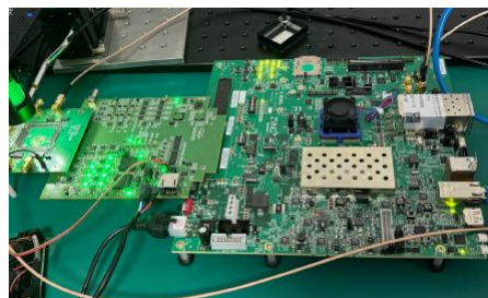
利用激光和放射源测试 COFFEE芯片性能
