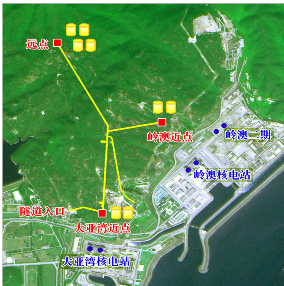
图 11.4: 大亚湾中微子实验现场地图。8组探测器(AD) 分别放置在大亚湾近点(2组), 岭澳近点(2组)和远点(4组)。
