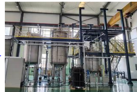
液闪混制 (LAB + PPO + bis-MSB + BHT)
