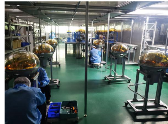
PMT防护罩组装
