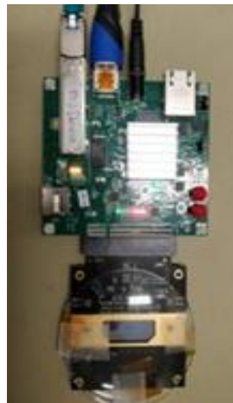
单片望远镜平面 ADENIUM DAQv2
