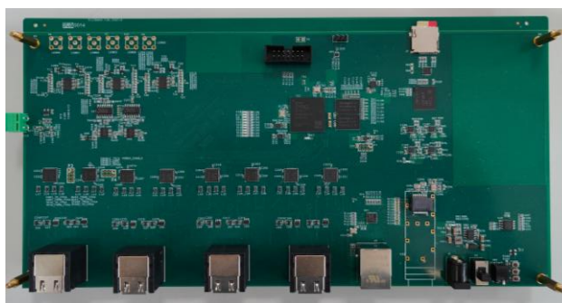
8端口触发分发端口TLU (郑大研究生 王龙 2025)
