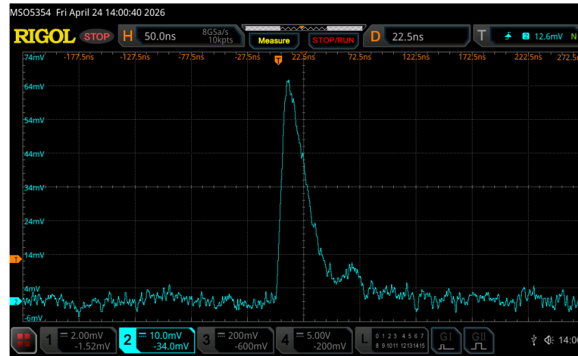
目前噪声偏大，放大倍数偏小，单光子湮灭在基线噪声内
