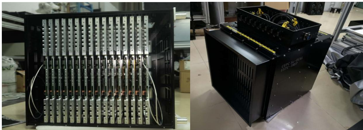
基于闪烁体+钨吸收体的电磁量能器样机 (中国)
