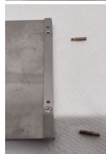
固定所有部件，定位销 用于组装下一个模块
