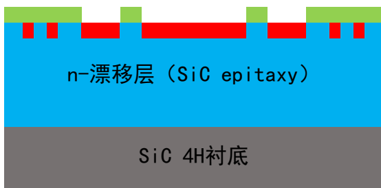
④刻蚀钝化层, 打开欧姆接触窗口
