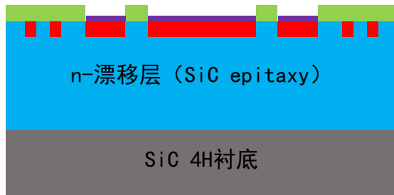
⑤溅射欧姆接触金属 (Ni/Ti/Al)
