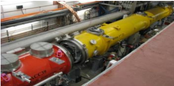
3 rd harmonic sc module 3.9 GHz
