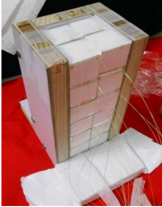
2 \times 2 \times 4 CsI(Na) module 2.5\text{cm} \times 2.5\text{cm} \times 2.5\text{cm}
