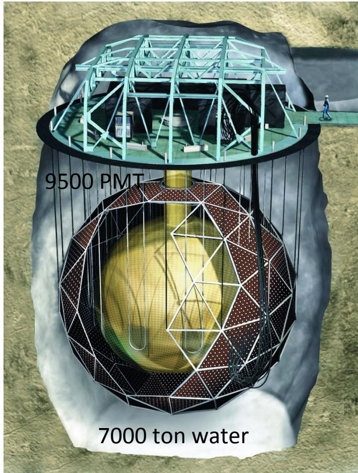
780 ton LAB+PPO in  $\varnothing 12\text{ m}$  acrylic vessel
