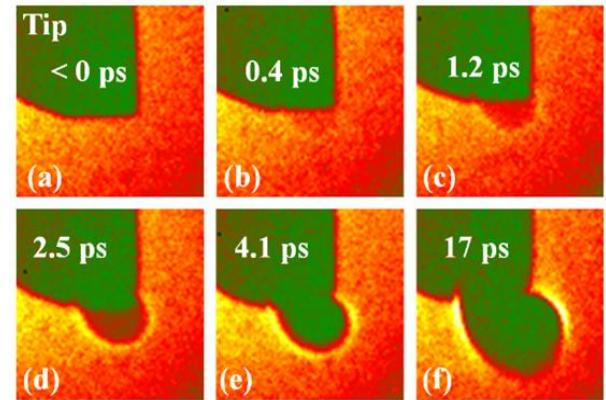
利用等离子体对电子束的扰动确定激光/电子的相对时间
