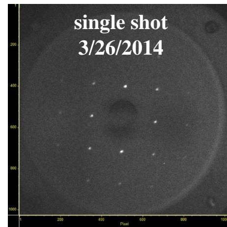
多晶铝和单晶金的衍射样斑 (*Fu et al., Rev. Sci. Instru. 2014*)
