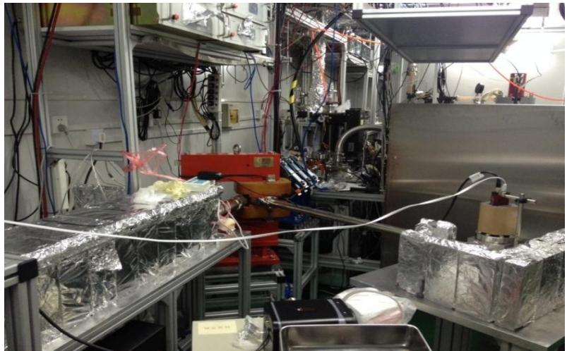
基于光阴极微波电子枪的加速器
