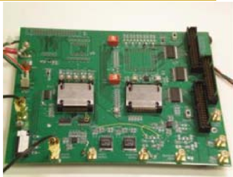
安装两块TOT芯片的测试板实物图
