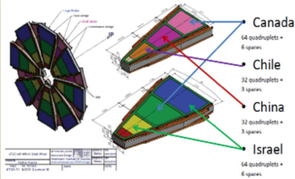
每个单独的探测层的位置分辨率为70-100 $\mu\text{m}$ （直接数字读出，信号的length正比与过阈时间，因此具有非常快的相应能力）
