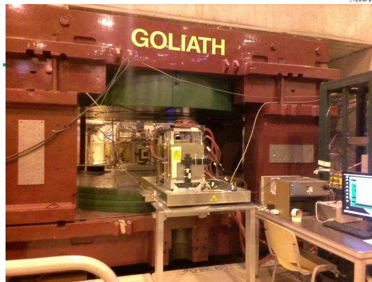
探测器模型在磁场下，前后各设置两个寻迹室体
