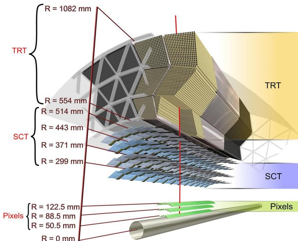
**TRT:** 数十个测量点有利于寻迹（精度低于硅微条），电子甄别能力，造价低（相对于硅探测器）
