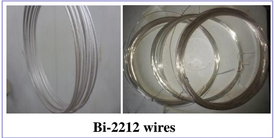
Bi-2212 线材在 4.2 K, 20 T,  $J_c > 1000$  A/mm<sup>2</sup>, 基本满足高场磁体和大电流缆线应用
