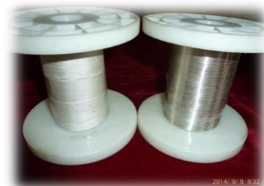
100米SiO<sub>2</sub>绝缘和加工后的线轮装2212线材
