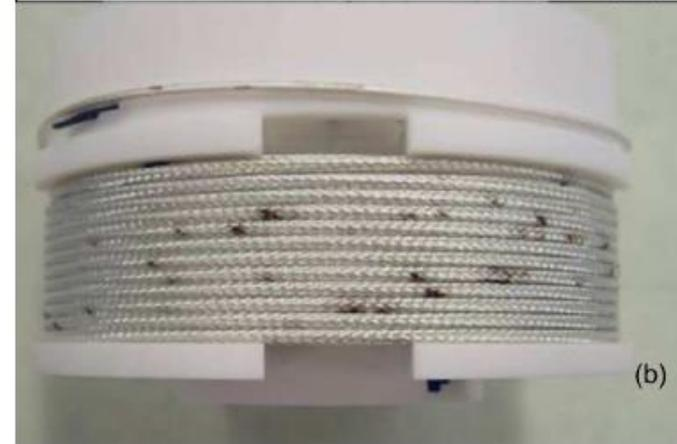
◆采用除气工艺，有效防止了内部气体在线材银层形成气孔，防止了线材的热处理渗漏问题
