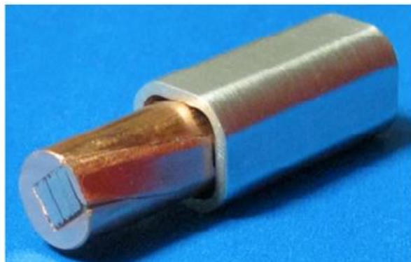
直接堆叠导体的CICC 导体
