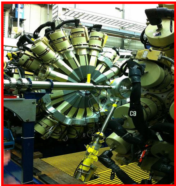
Gammaspere, 自发裂变 110 反康高纯锗, 液氮制冷
