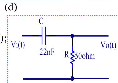
$$\begin{cases} V_o(\omega) = V_i(\omega) \times H(\omega) \\ H(\omega) = j\omega / (j\omega + 1/\tau) \\ V_i(t) = -Q/C_i \times \exp(-t/\tau_i) \rightarrow V_o(\omega) \\ V_i(\omega) = -Q/C_i \times 1/(j\omega + 1/\tau_i) \end{cases}$$
