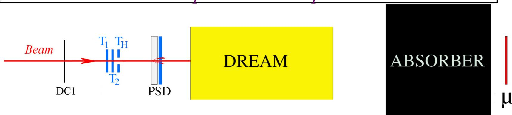
*Trigger* :  $(T_1 \cdot T_2 \cdot \overline{T_H})$
