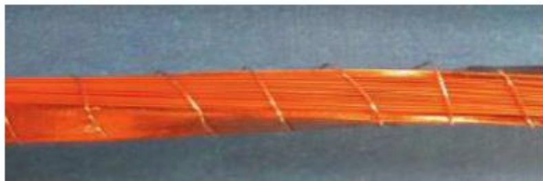
Twisted stacked Tape by MIT
