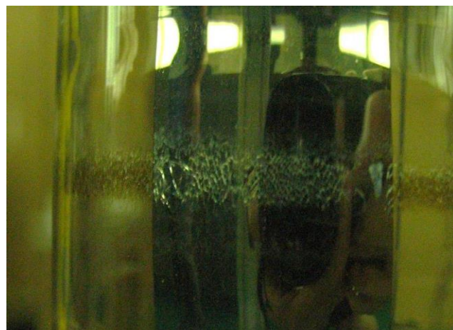
玻璃表面微裂纹
