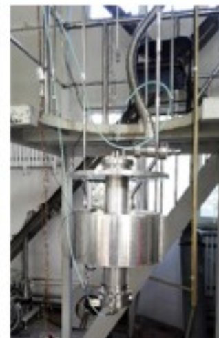
CEPC 650MHz超导腔 氮掺杂腔垂直测试
