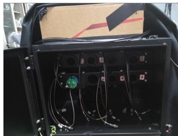
SPE, 高压响应曲线测试暗箱 暗噪声测试
