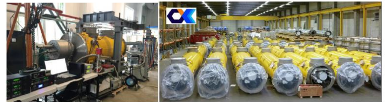
Fig. 6: IHEP ILC test cryomodule
