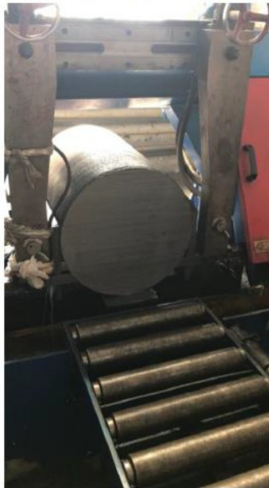
Nb ingot ( \Phi 480\text{mm} )
